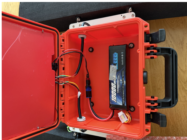
Batteriboksen åpen — koble inn LiPo-batteriet
